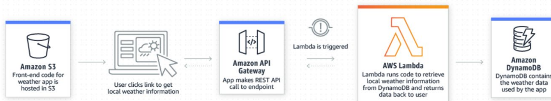
II·lustració 57. Esquema d'AWS per a mostrar un cas d'ús de Lambda en aplicacions web.
